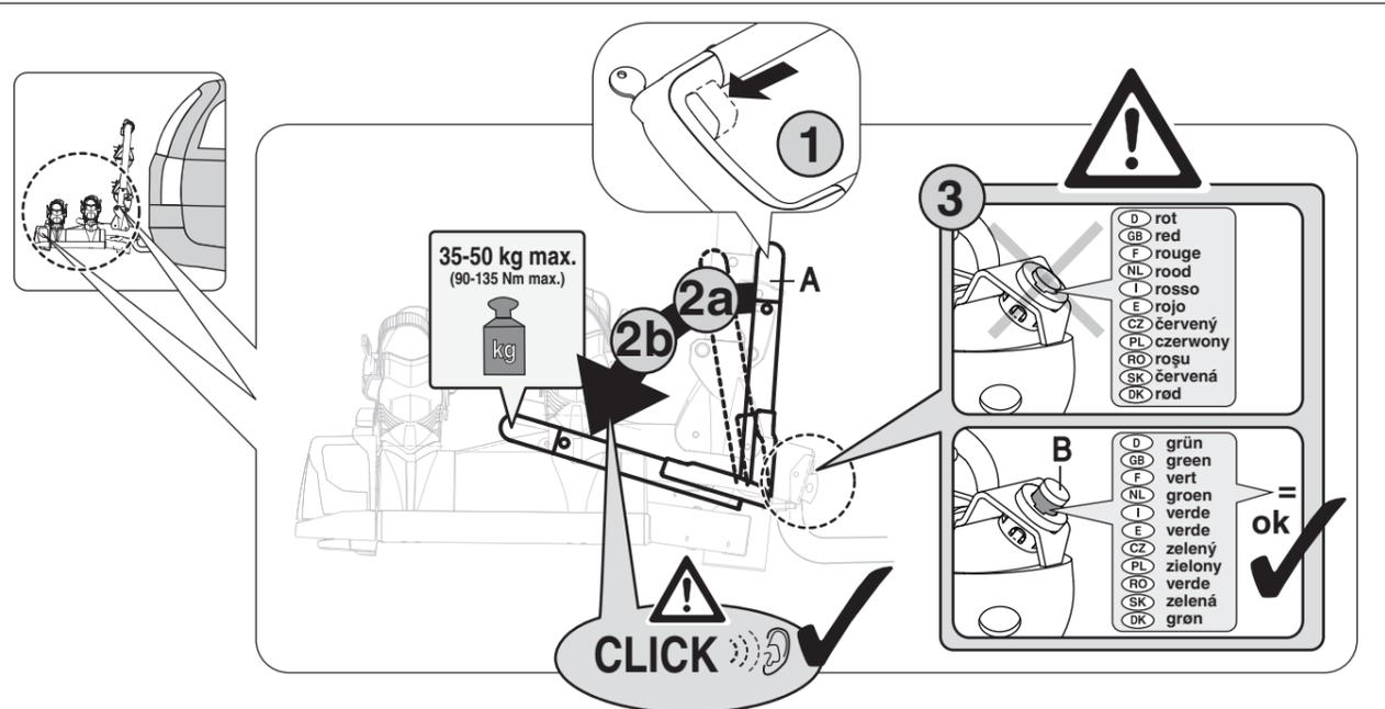
**D** Richten Sie den aufgesetzten Träger parallel zum Fahrzeugheck aus. Klappen Sie dann den Spanngriff (A) mit gedrücktem Entriegelungshebel (1) ca. 20 Grad ab (2a). In dieser Stellung den Entriegelungshebel wieder loslassen, dann erst den Spanngriff mit festem Druck nach unten klappen und hörbar einrasten (»CLICK«, 2b). Kontrollieren Sie dann den Kupplungsindikator (B), der bei korrekt aufgesetztem Träger grün anzeigen muss (3).
